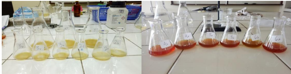
Gambar 1. Asam asetat dan NaOH sebelum dan sesudah dititrasi pada variabel waktu 10, 20, 30, 40, 50, dan 60 menit (TNR 11)
